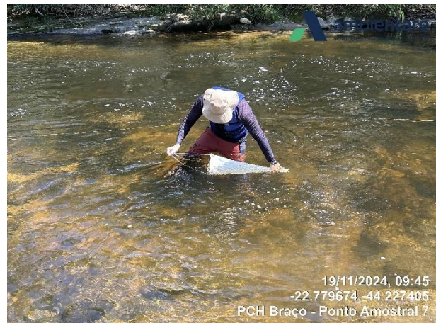
Figura 5-23: Obtenção das amostras de zooplâncton com rede de plâncton de 63\ \mu\text{m} de abertura de malha. Fonte: Ambientare: Soluções em Meio Ambiente (2025)
