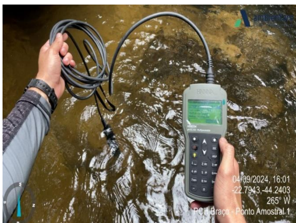
Figura 6-6: Exemplo de obtenção dos parâmetros físico-químicos com a utilização de sonda multiparâmetros. PCH Braço. Período seco. Setembro/2024 Fonte: Ambientare: Soluções em Meio Ambiente (2025).
