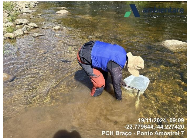
Figura 5-21: Coleta das amostras de zoobentos com auxílio de um amostrador do tipo Surber. PCH Braço. Fonte: Ambientare: Soluções em Meio Ambiente (2025)
